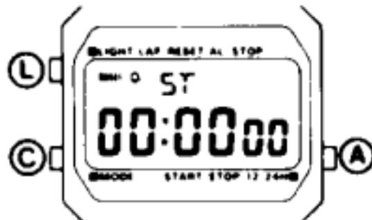
Операции запуска, остановки, разделения и сброса подтверждаются исполнением сигнала. Общий измеряемый интервал времени ограничивается 23 часами 59 минутами 59,99 секундами. Для измерения больших интервалов времени сбросьте показания секундомера и начните отсчет снова.
