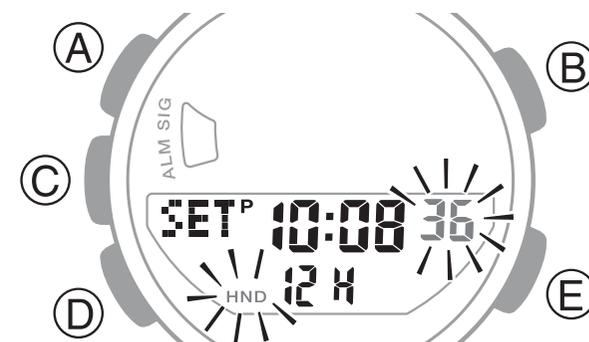
3. Нажмите кнопку А для перевода часов в режим настройки единицы измерения длины запланированной дистанции.
