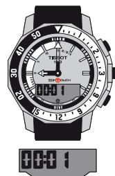
Режим погружения включен – Время погружения отображается на цифровом индикаторе, минутная стрелка указывает на ободке глубину погружения в метрах или футах, часовая стрелка указывает на циферблате скорость погружения в м/мин или футах/мин
