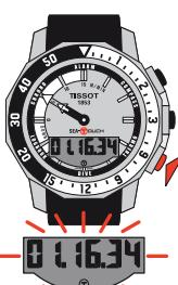
а) Остановка мигания индикатора, отображение промежуточного времени, работа хронографа в фоновом режиме
