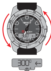
б) Повернуть ось 6 ч – 12 ч влево для совмещения отметки 12 ч с азимутальным направлением
